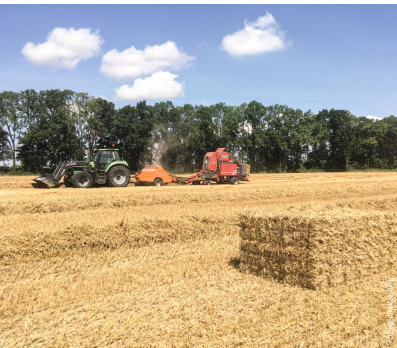
Traktor mit Kleinballenpresse und direkt dahinter laufendem Ballenbündler, vorne Paket mit 21 Kleinballen
