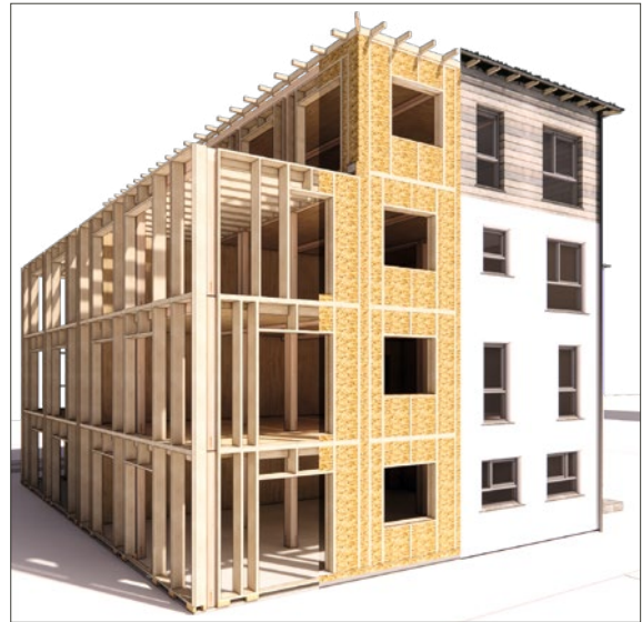
Bohlenständerwand: Strohausfachung/Kalkputz/Holzschalung (3D-Visualisierung)
