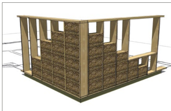
Ausfachender, nicht druckbelasteter Strohballenbau
