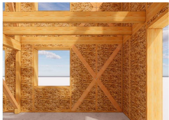
Streben im Stroh als Aussteifung (3D-Visualisierung)
